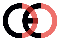
Falsk CE-mærke (for tæt på hinanden)
